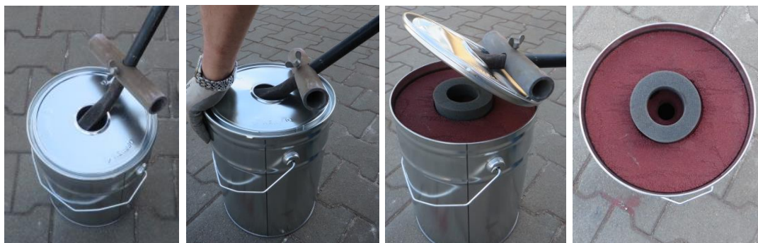
Figure 2 : ouverture du creuset jetable I chargé avec ouvre-creuset
